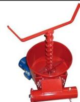
Schneckenkasten mit Rührwerk für schwerfließende Güter
