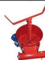
Schneckenkasten mit Rührwerk für schwerfließende Güter
